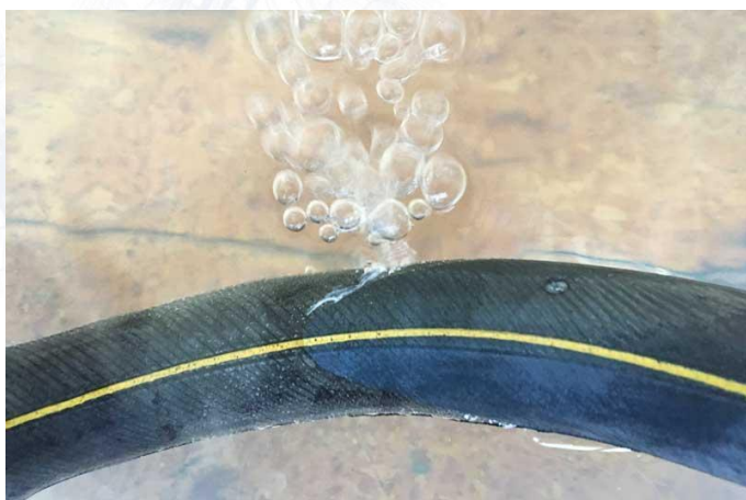
Le "bollicine" che rivelano una foratura.
