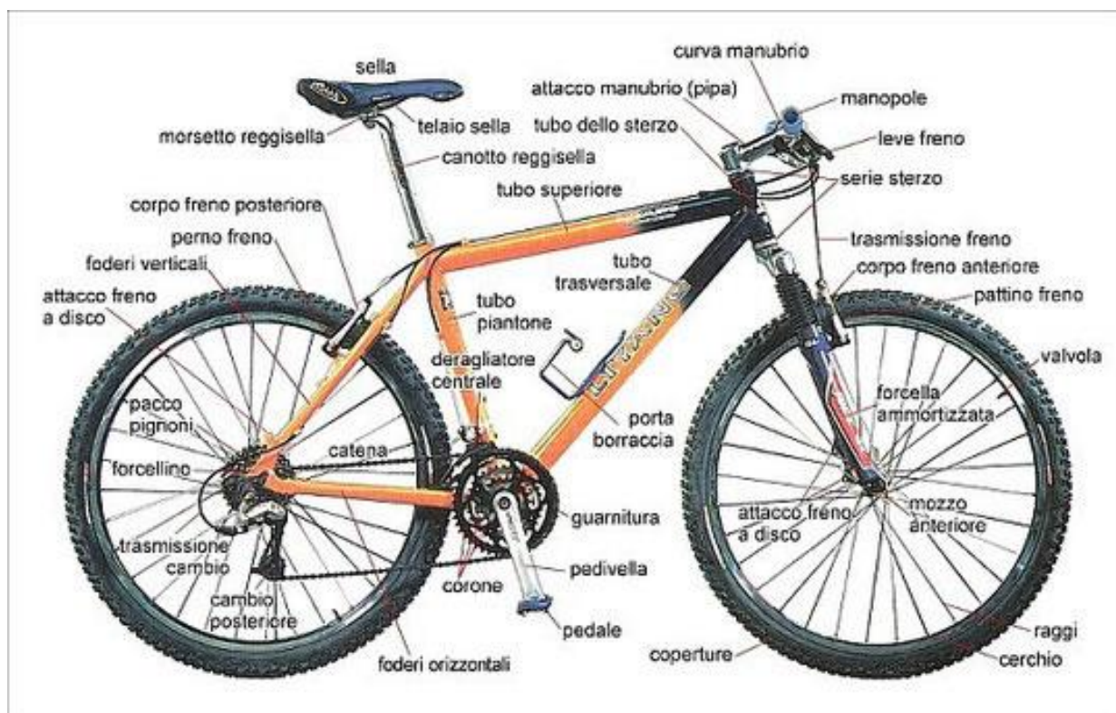
Nomenclatura delle parti della bicicletta (courtesy: Gio Bike).
